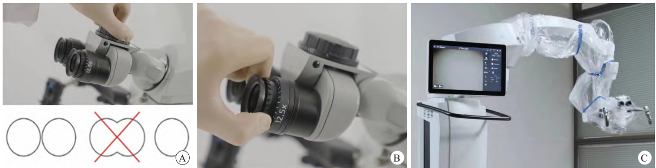
A. 调节瞳距为55~75 mm,使用前根据术者的瞳距来调节目镜之间的距离,以保证两个目镜中的图像重合到一起(双圈代表初始视野,红叉代表双眼视野没有完全融合,单圈代表双眼视野完全融合);B. 调节屈光度;C. 显微镜无菌保护套的准备。
